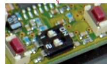
Basis instellingen door middel van push buttons op de sensor
